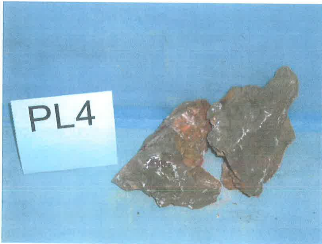
ΦΩΤ.: ΔΕΙΓΜΑ PL4 ΔΟΚΙΜΙΟ POINT-LOAD ΜΕΤΑ ΤΗ ΔΟΚΙΜΗ
