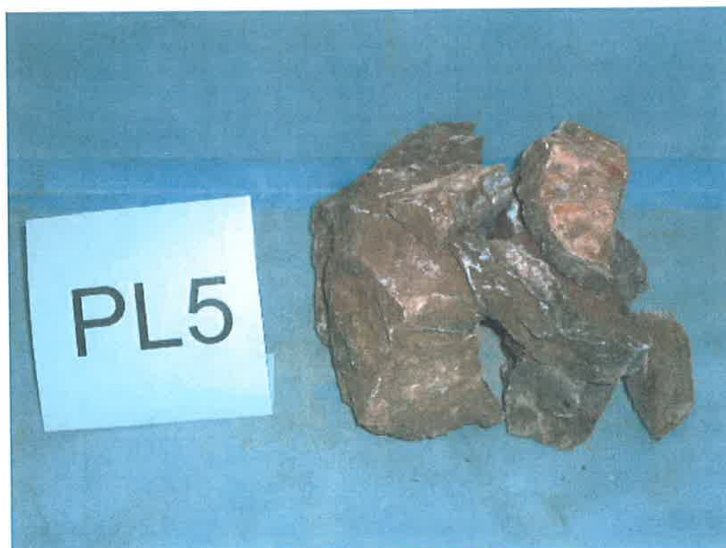
ΦΩΤ.: ΔΕΙΓΜΑ PL5 ΔΟΚΙΜΙΟ POINT-LOAD ΜΕΤΑ ΤΗ ΔΟΚΙΜΗ
