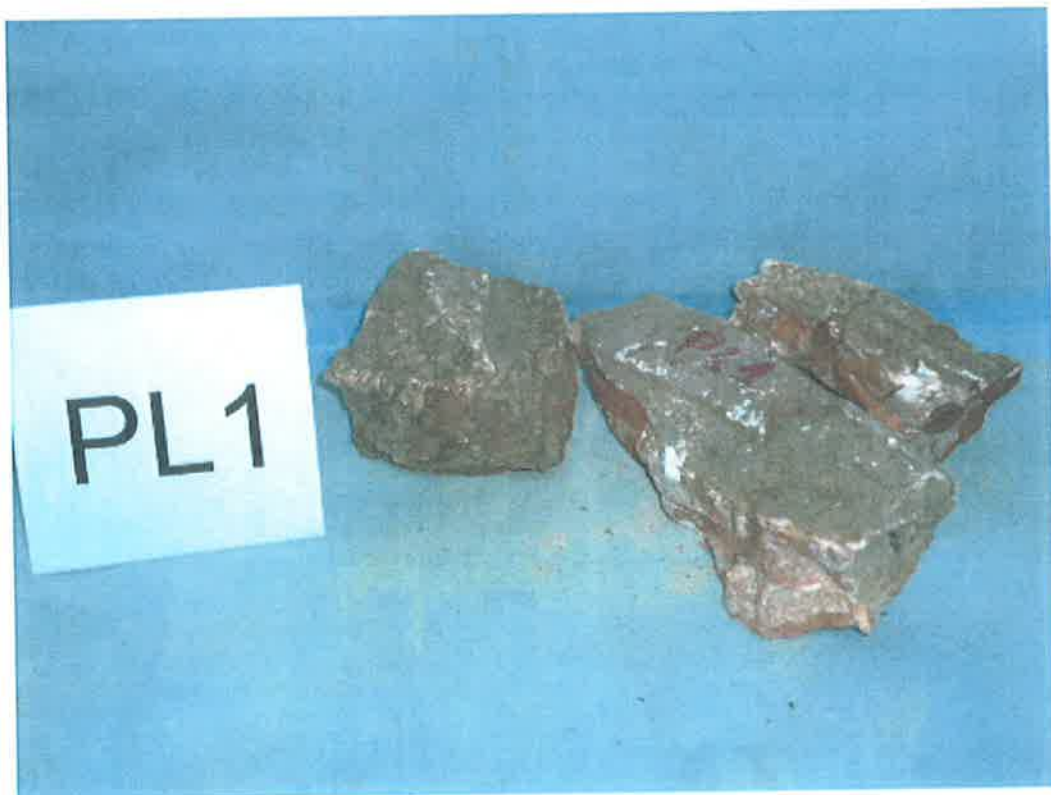
ΦΩΤ.: ΔΕΙΓΜΑ PL1 ΔΟΚΙΜΙΟ POINT-LOAD ΜΕΤΑ ΤΗ ΔΟΚΙΜΗ
