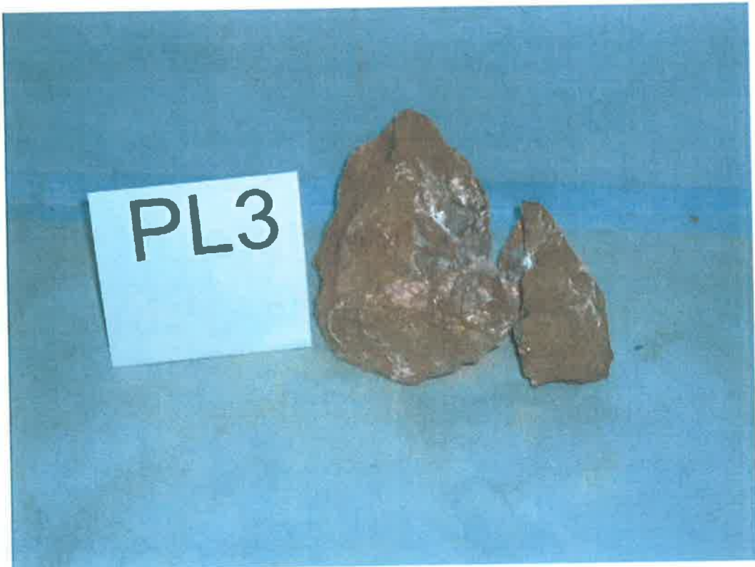
ΦΩΤ.: ΔΕΙΓΜΑ PL3 ΔΟΚΙΜΙΟ POINT-LOAD ΜΕΤΑ ΤΗ ΔΟΚΙΜΗ
