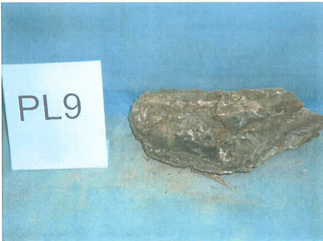
ΦΩΤ.: ΔΕΙΓΜΑ PL9 ΔΟΚΙΜΙΟ POINT-LOAD ΜΕΤΑ ΤΗ ΔΟΚΙΜΗ
