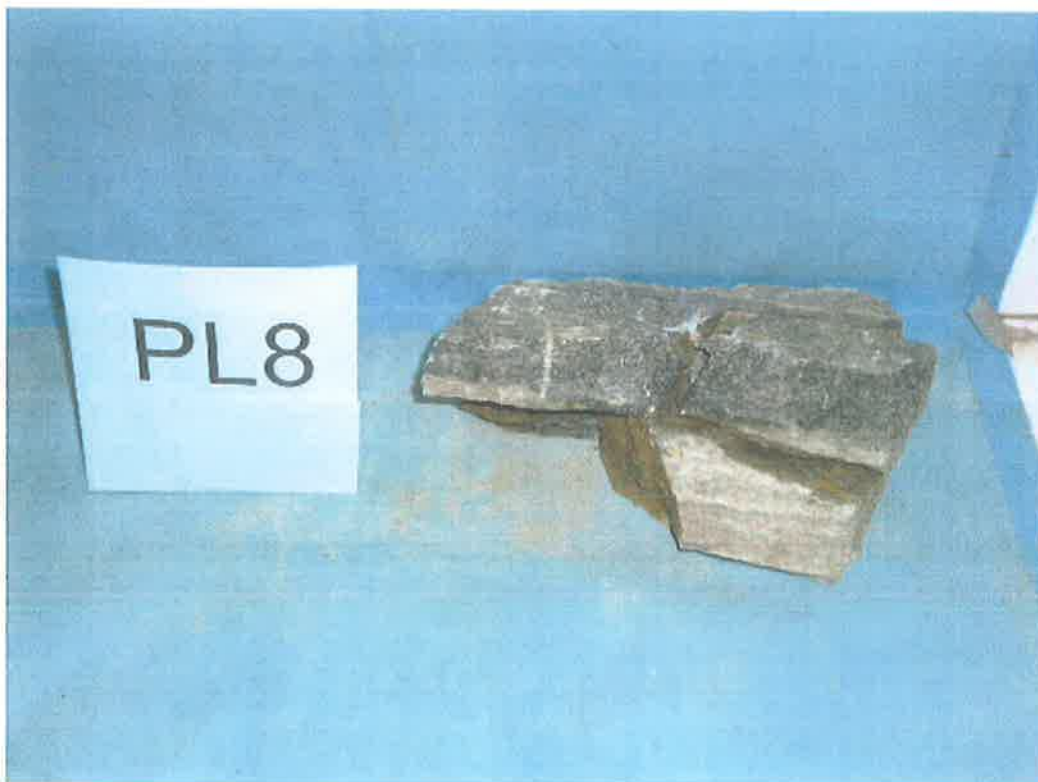
ΦΩΤ.: ΔΕΙΓΜΑ PL8 ΔΟΚΙΜΙΟ POINT-LOAD ΜΕΤΑ ΤΗ ΔΟΚΙΜΗ
