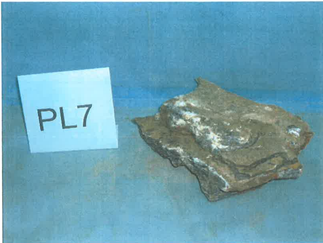
ΦΩΤ.: ΔΕΙΓΜΑ PL7 ΔΟΚΙΜΙΟ POINT-LOAD ΠΡΙΝ ΤΗ ΔΟΚΙΜΗ
