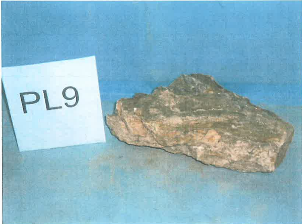
ΦΩΤ.: ΔΕΙΓΜΑ PL9 ΔΟΚΙΜΙΟ POINT-LOAD ΠΡΙΝ ΤΗ ΔΟΚΙΜΗ
