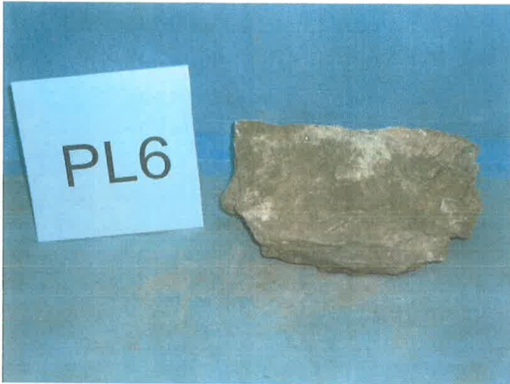
ΦΩΤ.: ΔΕΙΓΜΑ PL6 ΔΟΚΙΜΙΟ POINT-LOAD ΠΡΙΝ ΤΗ ΔΟΚΙΜΗ
