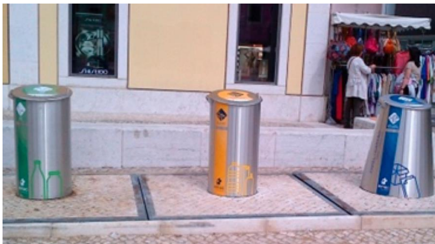
Εικόνα 20 Σύστημα ΠΟΠ υπόγειων κάδων που λειτουργεί με κάρτα για την πρόσβαση και την παρακολούθηση της συχνότητας χρήσης.
